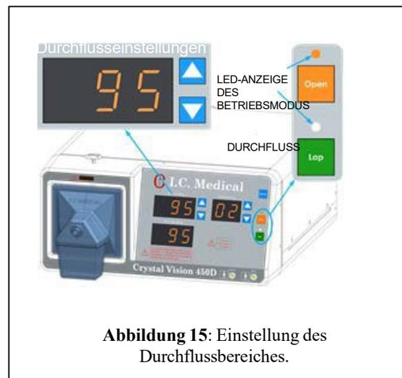
Abbildung 15: Einstellung des Durchflussbereiches.
