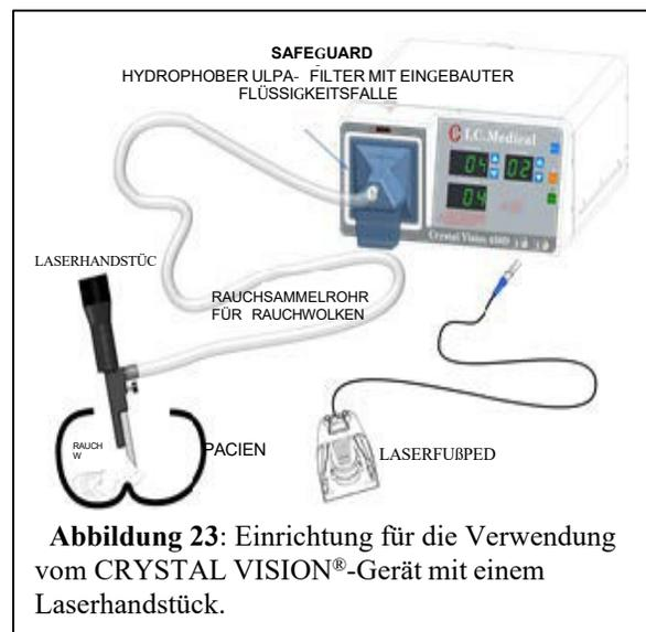
**Abbildung 23:** Einrichtung für die Verwendung vom CRYSTAL VISION®-Gerät mit einem Laserhandstück.
