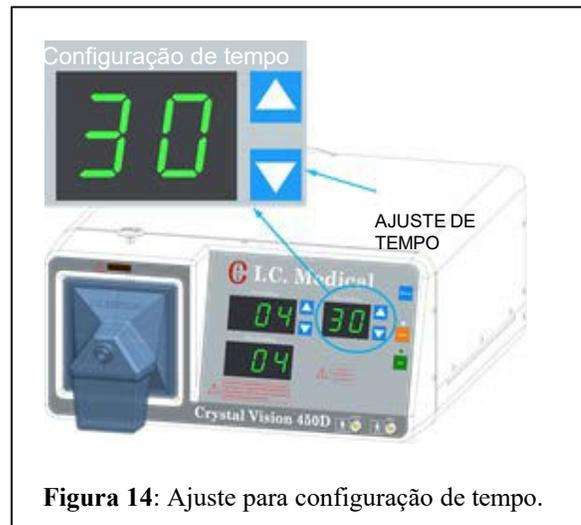
Figura 14: Ajuste para configuração de tempo.
