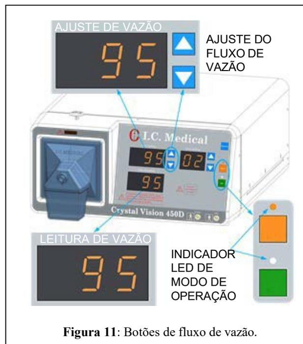
**Figura 11:** Botões de fluxo de vazão.
