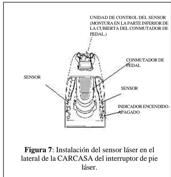
Figura 7: Instalación del sensor láser en el lateral de la CARCASA del interruptor de pie láser.
