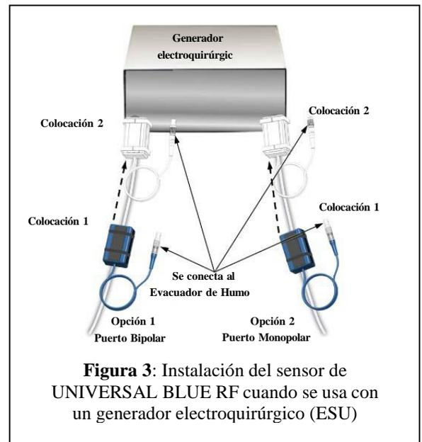
**Figura 3:** Instalación del sensor de UNIVERSAL BLUE RF cuando se usa con un generador electroquirúrgico (ESU)
