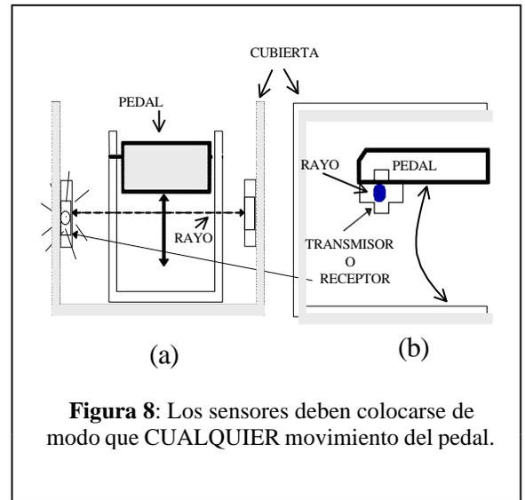
**Figura 8:** Los sensores deben colocarse de modo que **CUALQUIER** movimiento del pedal.
