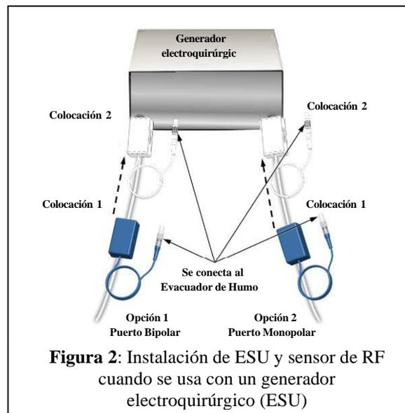
**Figura 2:** Instalación de ESU y sensor de RF cuando se usa con un generador electroquirúrgico (ESU)
